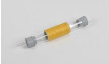
Pour obtenir des flux de vapeur sans eau de condensation lors de la détermination de la chaleur de condensation.
