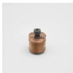
Pour étudier l'échauffement en fonction du travail de frottement ou de l'énergie électrique et déterminer la capacité thermique (massique).
