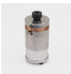
Pour étudier l'échauffement en fonction du travail de frottement ou de l'énergie électrique et déterminer la capacité thermique (massique).
