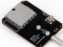
Lampe DEL pour des expériences d'étudiant sur l'optique de faisceau dans le Caisse de boîte à lumière (459093) et pour l'optique géométrique sur le rail métallique de précision (46082).
