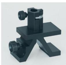
Cavalier pour banc d'optique à profil normalisé.
