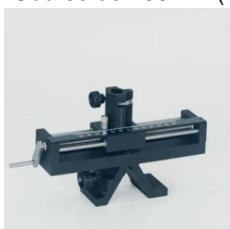
Cavalier pour banc d'optique à profil normalisé. Pour déplacer manuellement les composants optiques perpendiculairement à l'axe optique. Pour démonstrations et expériences en laboratoire de haute précision.
