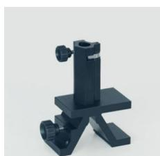
Cavalier pour banc d'optique à profil normalisé.
