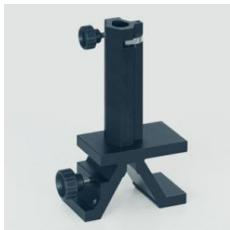
Cavalier pour banc d'optique à profil normalisé.
