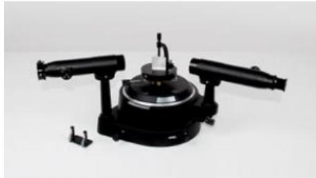
Pour observer et mesurer les spectres d'absorption et d'émission.
