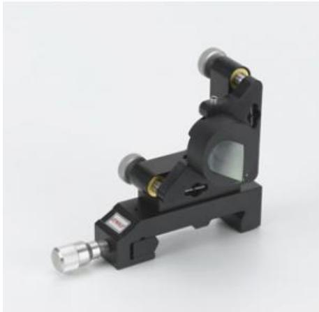
Un prisme de Littrow à surface arrière fortement réfléchissante (> 99,9 %) pour accorder le laser hélium-néon sur une raie orange (612 nm).
