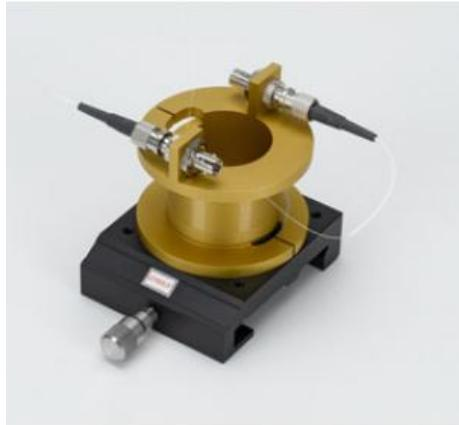
Ce module est la pièce maîtresse de l'installation et l'un des composants les plus précieux. Il se compose d'une fibre dopée à l'erbium de 4 m, enroulée sur un tambour. Les extrémités de la fibre sont reliées à des connecteurs ST qui sont eux-mêmes reliés à la prise de fibre.
