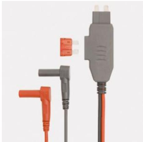
Adaptateur de contrôle bipolaire avec douilles de 4 mm et câbles de mesure à utiliser dans un porte-fusibles automobile. Se branche à un multimètre afin de pouvoir alimenter une tension ou encore de mesurer le courant absorbé par des consommateurs ou des courants de fuite sans avoir à débrancher de câble.
