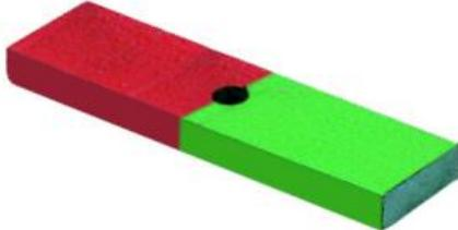
À suspendre ou à enficher sur le roulement à billes ( 34243 ), convient également pour les bobines ( 590 83 /84 ) destinées aux expériences sur l'induction.
