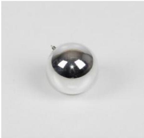
Pour l'étude du transport de la charge entre deux plaques électrisées (condensateurs à plaques 54422 /23) ; sphère creuse avec ?illet et fil isolant.
