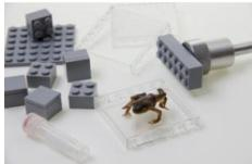
Permet la fixation d'objets au goniomètre en vue d'un examen tomodensitométrique ; comprend plusieurs objets. Le jeu de briques lego est conçu de manière à pouvoir également servir de porte-objets sur lequel il suffit de coller les petits objets à examiner.
