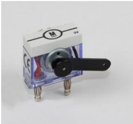
Moteur CC pour l'excitation d'oscillations mécaniques avec le pendule ou d'ondes mécaniques avec une corde élastique ou un ressort à boudin.
