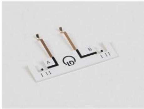
Balai bipolaire pour la connexion électrique du rotor bobiné aux circuits sur la plaque à réseau ( 57674 ).
