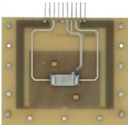
Platine amovible pour l'étude de la conductivité pour du germanium non dopé en fonction de la température. Cristal de Ge brasé sur une platine amovible pour l'appareil de base pour l'étude de l'effet Hall, avec des contacts pour le courant transversal, chauffage par résistance intégré avec thermo-sonde directement sous le cristal.
