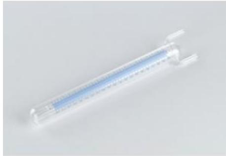
Manomètre à tube plongeur d'après Schiele, gradué. Recommandé comme instrument de contrôle de la pression pour les expériences avec les seringues à gaz.
