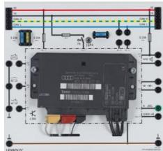
Original unité de commande d'automobile pour l'évaluation du commutateur des feux marche arrière et pour connecter un dispositif de test de diagnostic automobile (z. B. 7379803) via la prise OBD 738975 le système d'éclairage automobile avec bus CAN, 738111.
