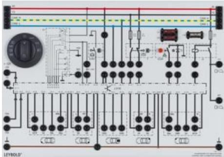
Comprend une unité de contrôle du réseau de bord et le système électronique de colonne de direction.
