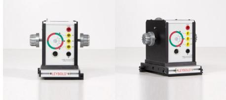
Pour détecter la position du rotor d'un moteur à courant continu sans balais et à aimants permanents (machine synchrone auto-pilotée).
