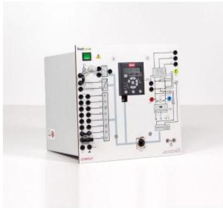
Convertisseur de fréquence industriel didactique avec circuit intermédiaire de tension pour la génération d'une tension de sortie triphasée, variable en fréquence et en amplitude, à partir du réseau alternatif monophasé. Utilisable pour la commande de vitesse et la régulation de vitesse et de couple de machines asynchrones et de machines IPM de la classe de puissance 0,3 kW. Face avant avec schéma fonctionnel pour la représentation de différentes fonctions des entrées et des sorties.
