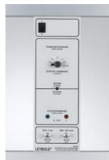
Pour une ventilation continue. La pompe peut également servir à générer un vide partiel. Le débit est commandé soit manuellement (via le bouton rotatif) soit par voie externe (par une tension de commande de 0 à 10 V).
