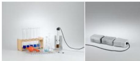
Si on mesure l'absorbance d'une solution, on peut en déduire sa concentration. Ce rapport est décrit par la loi de Beer-Lambert. Outre de la concentration  $c$  d'une solution, l'absorbance dépend également de l'épaisseur de couche  $d$  et du coefficient d'extinction spécifique de la substance  $\epsilon$ .
