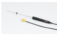
Thermocouple NiCr-Ni dans gaine en acier inoxydable, type K (fiche jaune selon la norme ANSI) avec prise plate normalisée pour une utilisation avec CASSY et le connecteur adaptateur NiCr-Ni S (524 0673) ou directement avec l'adaptateur chimie (524 067) et le Mobile CASSY 2 (524 005).
