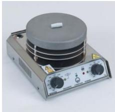
Agitateur magnétique (jusqu'à 2 litres) avec plaque chauffante en aluminium, pour des exercices de chauffage et d'agitation simples ; à régulation électronique de la plaque chauffante et de la température des milieux chauffés jusqu'à 350 °C. Protection contre la surchauffe, raccord pour thermomètre à contact, conforme à la norme DIN 12878, possibilité de fixer une tige. Livré complet avec câble et prise secteur.
