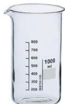
Forme haute, avec bec verseur, ISO 3819, DIN 12331
