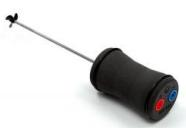
Pour les calorimètres 666 429 et 667 325 pour le mélange du liquide du calorimètre ou comme agitateur pour d'autres récipients avec un filetage GL 32.
