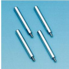
Pour des expériences de magnétisation et de démagnétisation ainsi que pour mettre en évidence que les barres séparées sont des dipôles magnétiques. Barres pourvues de filetage et de douilles filetées permettant leurs assemblage.
