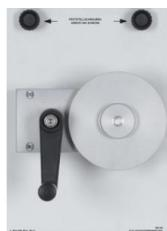
Avec poulie, manivelle et courroie, pour l'entraînement des rotors de l'équipement Machines Électriques d'Enseignement; sur plaque d'expérience avec deux arrêtoirs.
