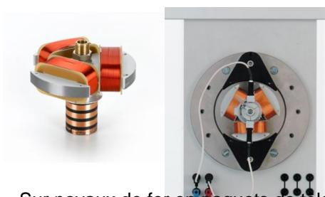
Sur noyaux de fer en paquets de toiles feuilletées sans courant parasite ; avec coussinet de pivotement, poulie et tambour d'enroulement.
