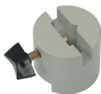
Pied cylindrique avec vis de fixation pour le serrage de plaques ou de tiges ; le dessous comporte une rainure rectangulaire qui lui permet de coulisser sur une règle graduée (par ex. 31102). La rainure médiane du dessus permet de fixer une règle graduée.
