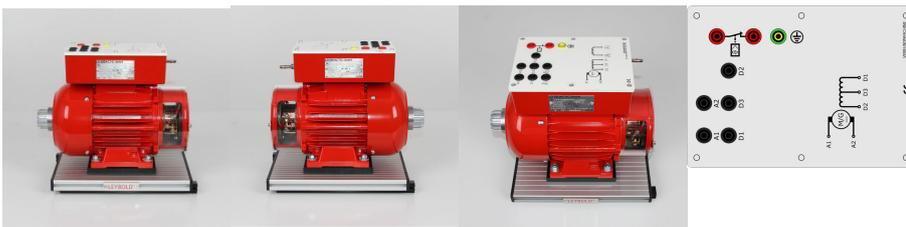
La machine avec une extrémité d'arbre est isolée et construite sur une base en aluminium avec des patins.
