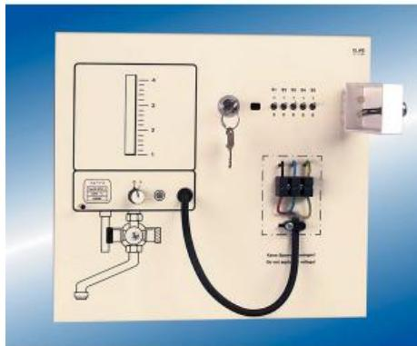
Le simulateur d'erreurs 0701 a été développé pour la formation et l'utilisation lors des examens afin de s'entraîner aux contrôles partiels nécessaires et à la recherche systématique des erreurs.
