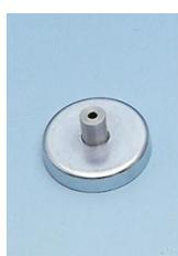
Pour la fixation de composants à fiche de 4 mm, par ex. une poulie ( 340911ET2 / 340 921ET2 ), sur le tableau magnétique ( 301 301 ) ; avec film protecteur permettant de déplacer l'embase sans faire de rayures.
