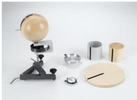
Durant l'expérience P1.4.5.2, on compare entre eux les moments d'inertie du cylindre creux, du cylindre plein et de la sphère pleine.
