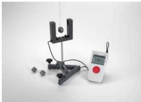
Dans l'expérience P1.5.1.7, on utilise un poids sur une fil pour déterminer l'accélération de la pesanteur. Comme la masse du poids est considérablement plus élevée que celle du fil auquel il pend, le pendule peut être considéré comme une bonne approximation d'un pendule mathématique.
