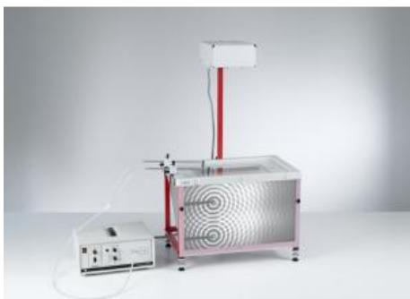
Durant l'expérience P1.6.5.1, on compare l'interférence entre deux ondes circulaires cohérentes avec la diffraction d'ondes rectilignes par une fente double.
