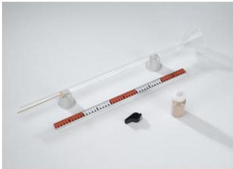
Durant l'expérience P1.7.3.1, on étudie des ondes sonores stationnaires avec un tube de Kundt. De la poussière de liège s'élevant en tourbillons dans les ventres d'oscillation rend visibles les ondes sonores dans le tube. On détermine la longueur d'onde  $\lambda$  d'après l'écart entre les nœuds d'oscillation.
