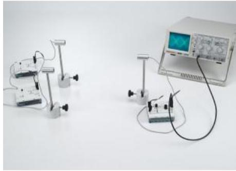
Au cours de l' expérience P1.7.5.1, on utilise deux transducteurs ayant des fréquences  $f_1$  et  $f_2$  légèrement différentes pour étudier les battements des ondes ultrasonores.
