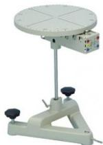
Pour les expériences qui nécessitent une rotation régulière et dont les angles doivent être mesurés sur un enregistreur ou une interface (CASSY), par exemple lors d'expériences sur la diffraction (ultrasons) ou sur la distribution des angles (micro-ondes).
