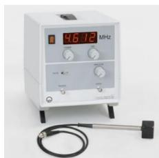
Générateur d'ultrasons avec transducteur acoustique pour la production d'une oscillation mécanique continue (4Mhz - 5MHz) ou d'impulsions individuelles.
