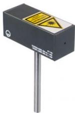
Source lumineuse monochromatique compacte, spécialement conçue pour des expériences sur l'interférence et la diffraction.
