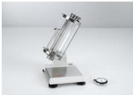
Durant l'expérience P1.8.3.2 , on étudie à température ambiante quelle est l'influence de la concentration d'une solution sur sa viscosité sur l'exemple de solutions de sucre concentrées.
