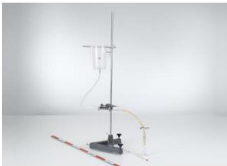
Pour un fluide newtonien (écoulement laminaire, par ex.), la loi de Hagen-Poiseuille décrit la relation entre le débit volumique  $J$  et la différence de pression :
