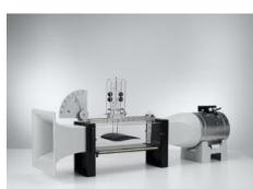
Au cours de l' expérience P1.8.7.1, on mesure la traînée aérodynamique FW et la poussée verticale FA d'une surface portante en fonction de l'angle d'attaque à de l'aile par rapport à la direction du courant.
