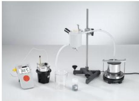
Pour déterminer la capacité thermique spécifique, on pèse au cours de l'expérience P2.3.2.2 différentes matières sous forme de grenade, on les chauffe à la température 1 avec de la vapeur d'eau puis on les jette dans une quantité d'eau pesée de température 2.
