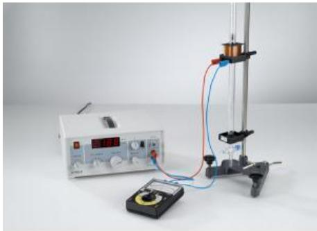
Durant l'expérience P2.5.3.2, on détermine l'indice adiabatique à l'aide de l'appareil de résonance à colonne à gaz.
