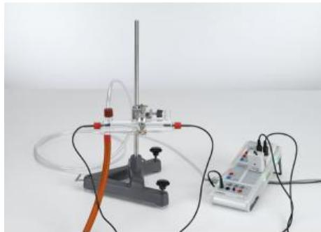
Dans l'expérience P2.5.4.1, le flux de gaz acheminé est rétracté et dilaté par une membrane. L'augmentation du volume occupé par le gaz derrière l'obstacle fait en sorte que l'écartement des particules moyen augmente, ceci entraînant une variation de la température du gaz. On détermine la pression et la différence de température en amont et en aval de la membrane.
