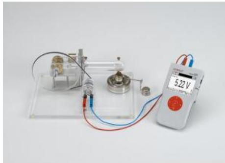
Dans l'expérience P2.6.1.5, le fonctionnement du moteur à air chaud P en tant que moteur thermique est étudié qualitativement.
