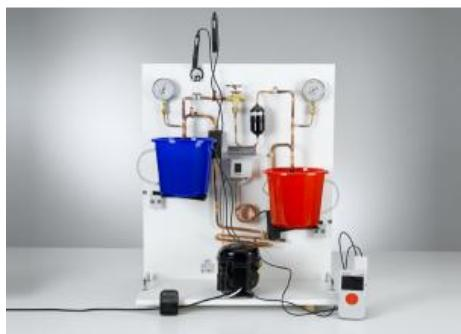
Au cours de l'expérience P2.6.3.2, on trace les températures  $T_f$  et  $T_h$  aux sorties de la vanne de détente et de l'évaporateur.
