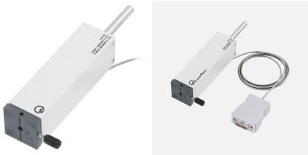
Pour mesurer des forces (par ex. électrostatiques) de  $\pm 1$  N avec CASSY ( 524013 , 524006 , 524005W , 524018 ) ou l'instrument de mesure universel Physique ( 531835 ). Avec deux lames souples à quatre jauge extensométriques montées en pont.
