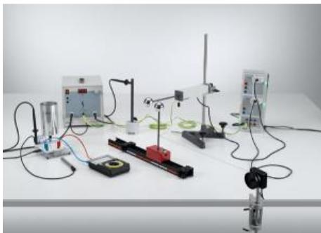
Pour l'expérience P3.1.2.3, on emploie le logiciel CASSY Lab pour tracer et exploiter les résultats des mesures. On mesure la force de Coulomb pour différentes charges Q1 et Q2 en fonction de la distance r.
