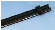
Banc d'optique pour démonstration et travaux pratiques.
