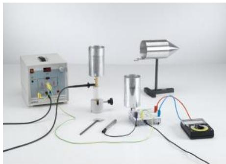
Dans l'expérience P3.1.5.1, on prélève la charge électrique d'un corps creux métallique chargé à l'aide d'une plaquette d'essai afin de la mesurer avec un coulombmètre.
