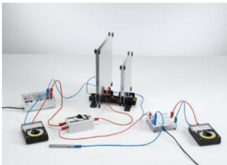
L'expérience P3.1.7.2 consiste à déterminer la capacité totale  $C$  du condensateur démontable, alors que les deux paires de plaques sont branchées en parallèle puis en série, avec une distance entre les plaques constante. On compare ensuite cette capacité  $C$  avec les capacités simples  $C_1$  et  $C_2$  des deux paires de plaques. Pour le montage en parallèle, l'exploitation confirme la relation
